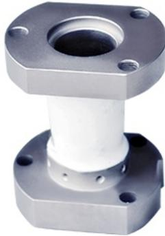
**НН3В** - тензометричний датчик крутного моменту. Датчики **крутного моменту** підходять для перевірки механічного крутного моменту та потужності обертових машин, залізничних двигунів, таких як електродвигуни, двигуни внутрішнього згоряння і т.д. Клас захисту тензодатчика **IP67**. Завдяки високій точності, маслостійкості, водонепроникності й стійкому до звичайних агресивних газів та речовин матеріалу, цей тип датчиків підходить для багатьох видів навколишньої середовища.
